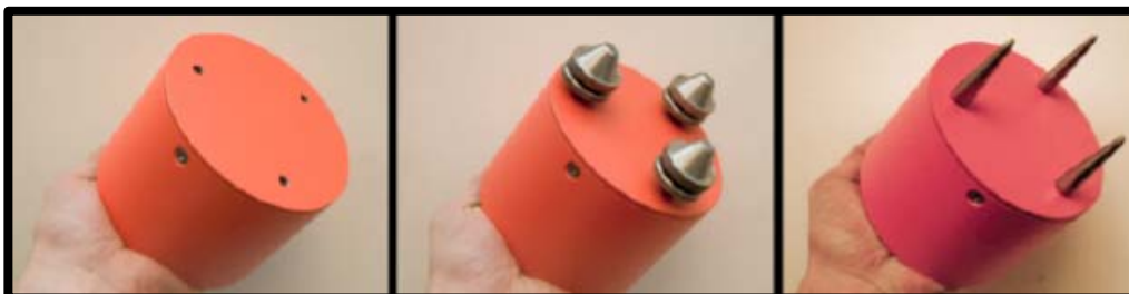
Figura A. 1 - Versione "GEMINI HVSR" basolare impiegata per la prospezione sismica passiva: dettaglio dei supporti intercambiabili in dotazione, da sostituire a seconda che si acquisisca su superficie rigida o su terreno.
